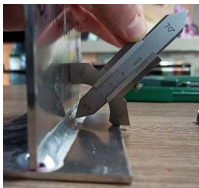
Rys. 6. Sposób pomiaru grubości spoiny
