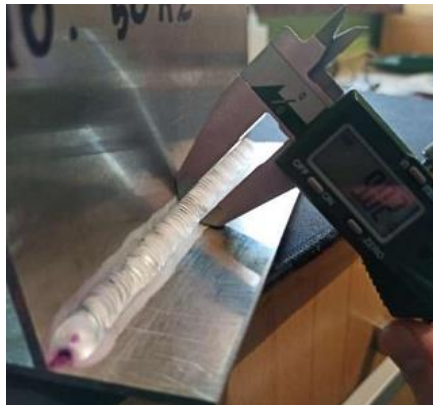
Rys. 5. Sposób pomiaru szerokości spoiny
